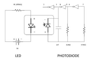
Led and Photodiode using IC 4049
